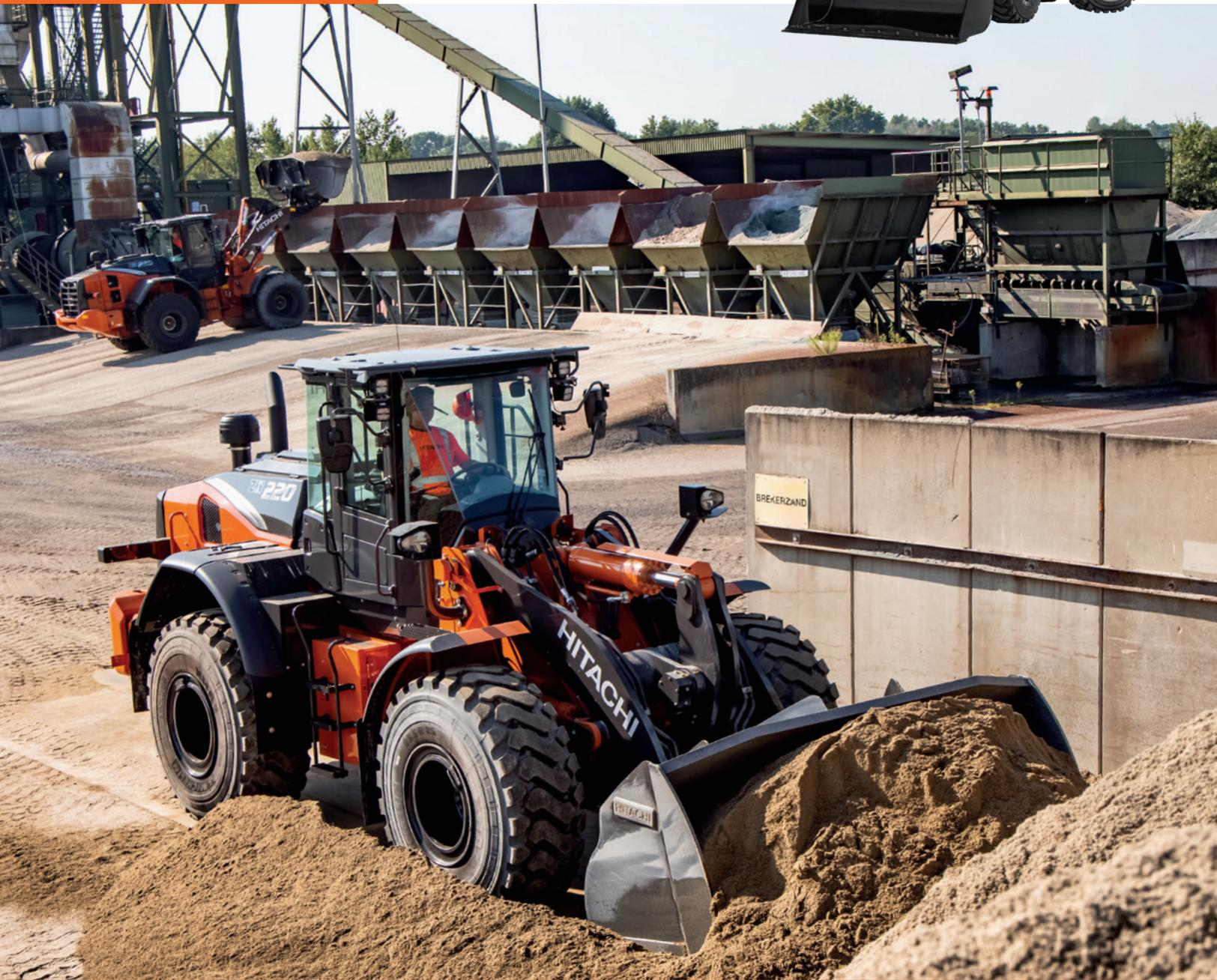
Capacité du godet : 3,7 à 4,7  $\text{vg}^3$  (2,8 à 3,6  $\text{m}^3$ )
