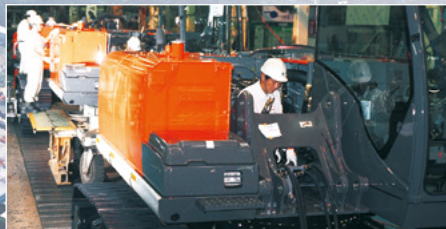
Línea de montaje de excavadoras medianas
