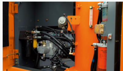
Filtros remotos agrupados y puntos de inspección
