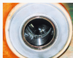
Pulverización térmica WC
