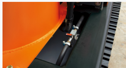
Grifo de vaciado de agua del tanque de combustible
