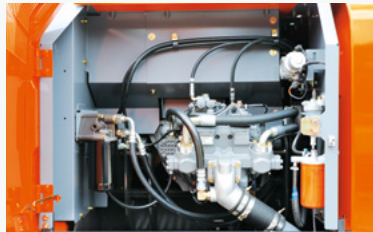
Filtros remotos agrupados y puntos de inspección
